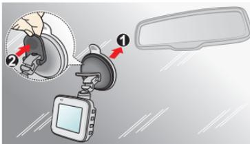
3. Lors du réglage de l'angle de montage, assurez-vous que le point de vue de la caméra est parallèle avec le niveau du sol, et que le ratio terre / ciel est proche de 6/4.
