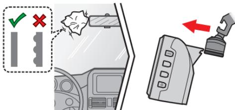
2. Fixez le support sur le pare-brise (❶) et appuyez sur la patte (❷) pour verrouiller la ventouse en place.
